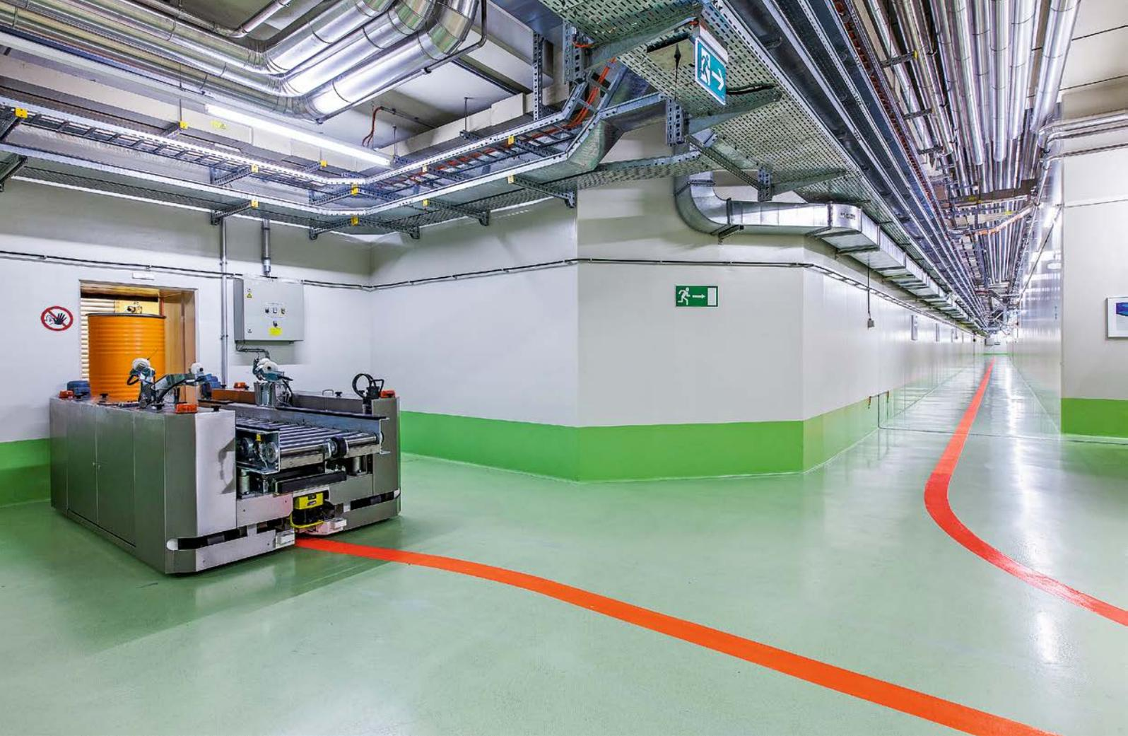
Transport automatisé d'un fût de déchets au dépôt intermédiaire central (Image : Zwiilag)
